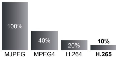
Komprimierungsverfahren verringern den Datenverkehr auf dem Netzwerk und erhöhen gleichzeitig die Aufzeichnungsdauer.
